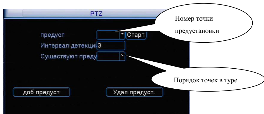
Рис. 3.14 Настройка тура обхода
